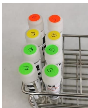
Figura 14: Tubos de ensayo del agua de entrada y salida usando los kits Spectroquant® y midiendo en el espectrofotómetro de la misma marca. Fuente: Milagros Peña (2023).
