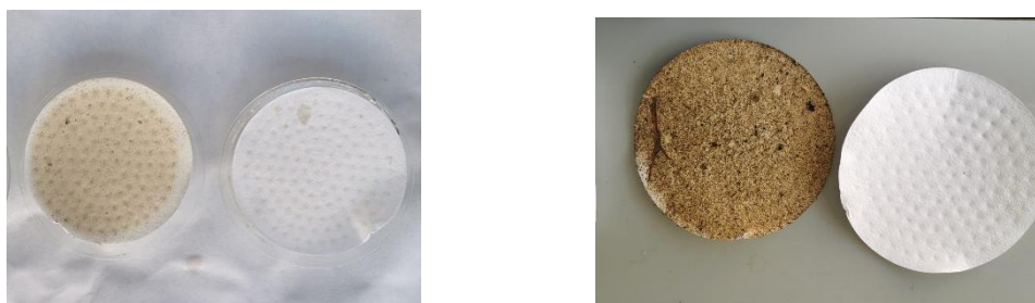
Figura 29: Filtros después de filtrar agua de entrada y agua permeada. La foto de la derecha, muestra el filtro de agua de entrada después de un episodio de lluvias. Fuente: Milagros Peña (2023).
