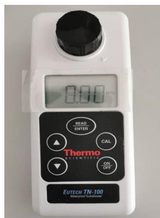
Figura 27: A) agua permeada. B) Medida (UTN) del agua permeada con el turbidímetro.
