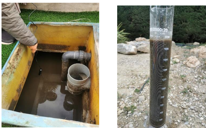
Figura 16: Foto de la medición de oxígeno en el compartimento 1 (desnitrificación) y medición del SVI por 30 min del fango del biorreactor (compartimento 2). Fuente: Milagros Peña (2023).
